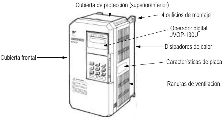
Figura 3 Identificación de las piezas - Modelo CIMR-G5U43P7
